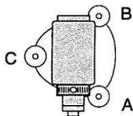
6. Установите угол наклона равным  $0^\circ$  с помощью подъемных винтов А и В для направления X, и с помощью подъемного винта С - для направления Y.
