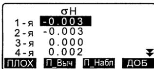
11. Нажмите клавишу **[П-Выч]** для выполнения повторных вычислений без использования точек, помеченных на шаге 10. Результат вычислений отображается на экране.
