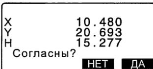
7. Введите расстояние от 2-го отражателя до измеряемой точки и нажмите клавишу **{ENT}**. На экране отображаются координаты измеряемой точки.
