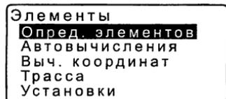
4. В экране <Опред. элементов> выберите "Ввод ВУ", чтобы ввести вершину угла.
