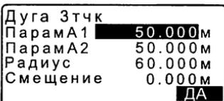
8. Нажмите **[ДА]** в экране на шаге 7, чтобы вычислить координаты и расстояние до точек КА1, КЕ1, КЕ2, КА2. Результаты вычислений отображаются на экране. Для переключения экранов <Дуга 3тчк/КА1>/<Дуга 3тчк/КЕ1>/<Дуга 3тчк/КЕ2>/<Дуга 3тчк/КА2> нажмите **[▶]**/**[◀]**.
