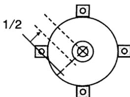
4. Удерживая верхнюю часть инструмента, снимите крышку винта оптического отвеса, затем снимите крышку сетки нитей. Установите на место крышку винта оптического отвеса. Используйте 4 юстировочных винта оптического отвеса для устранения оставшегося отклонения, как показано ниже.
