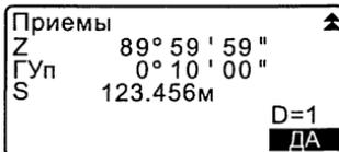
При измерении на 2-ю и последующие точки, если для параметра (1) Количество приемов при измерении расстояния (Кол. расст) выбрано значение "1", для параметра (2) Количество отсчетов при измерении расстояния (Кол. изм-й) выбрано значение "1" и для параметра (3) Наблюдение при круге "лево" и круге "право" (Набл. КЛ/КП) выбрано значение "Нет", на экране отображается клавиша **[СМЕЩ]**. Нажав **[СМЕЩ]**, можно выполнить измерение со смещением.
