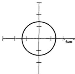
● Марка для юстировки лазерного отвеса
