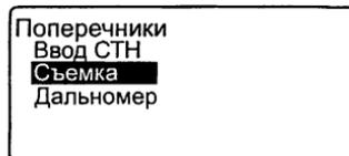
4. Введите имя трассы для съемки поперечника, шаг пикетажа (интервал между пикетами на осевой линии), приращение пикетов (шаг между пикетами поперечника), текущий пикет на осевой линии и укажите направление. Нажмите **[ДА]**.
