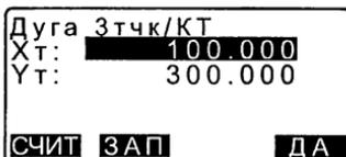
6. По координатам трех введенных точек вычисляются угол пересечения касательных (УП), направление кривой и длины отрезков БТ-ВУ и ВУ-КТ. Результаты вычислений отображаются на экране.
