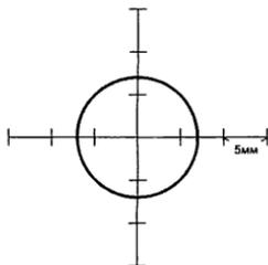
● Марка для юстировки лазерного отвеса
