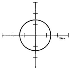
● Марка для юстировки лазерного отвеса
