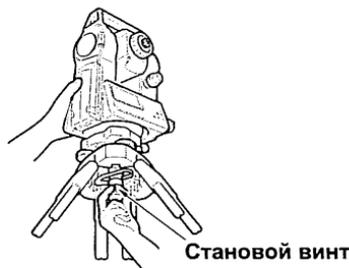
3. Смотря в окуляр оптического отвеса, вращайте фокусирующее кольцо окуляра оптического отвеса для фокусирования на сетке нитей. Вращайте фокусирующее кольцо оптического отвеса для фокусирования на точке съемки.
