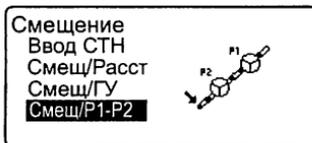
5. Наведитесь на 1-й отражатель и нажмите клавишу **[ИЗМЕР]**. Наблюдение начинается, и на экран выводятся результаты измерений. Нажмите **[ДА]**. Выводится экран наблюдения 2-го отражателя.
