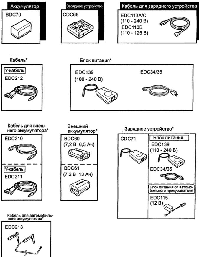
\*: Устройства, которые заказываются дополнительно для тахеометров СХ-102 и всех низкотемпературных моделей.
