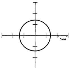
● Марка для юстировки лазерного отвеса
