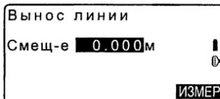
3. Наведитесь на отражатель и нажмите **[ИЗМЕР]** в экране на шаге 2. Результаты измерений отображаются на экране. Для остановки измерений нажмите **[СТОП]**.
