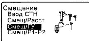
5. Наведитесь на смещенную точку и нажмите клавишу **[ИЗМЕР]** на 1-й странице режима измерений. Результаты измерений отображаются на экране. Чтобы остановить измерения, нажмите **[СТОП]**.
