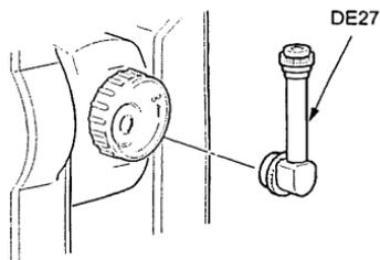
После снятия ручки тахеометра открутите закрепительное кольцо и снимите окуляр зрительной трубы. Затем прикрутите на его место диагональную насадку.
