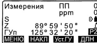
4. Наведитесь на вторую визирную цель. Выводится отсчет по горизонтальному кругу на вторую визирную цель с учетом установленного отсчета по горизонтальному кругу на первую точку.
