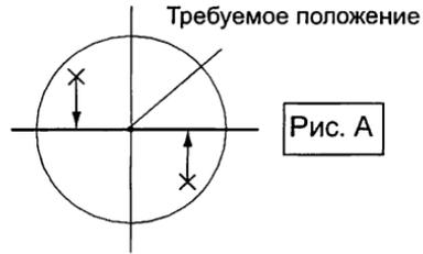
② Слегка ослабьте верхний (нижний) юстировочный винт и на такую же величину закрутите нижний (верхний) винт. Следите, чтобы затягивающее усилие для обоих винтов было одинаковым. Продолжайте юстировку до тех пор, пока пятно лазерного луча не совместится с горизонтальной осью марки.
