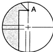
3. Используйте винт точной наводки зрительной трубы для перемещения цели в точку B на вертикальной линии сетки нитей. Если визирная цель перемещается параллельно вертикальной линии, юстировка не нужна. Если же она отклоняется от вертикали, предоставьте юстировку специалистам сервис-центра регионального дилера.
