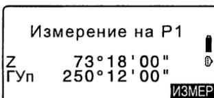
6. Наведитесь на 2-й отражатель и нажмите клавишу **[ИЗМЕР]**. Результаты измерений отображаются на экране. Нажмите **[ДА]**.
