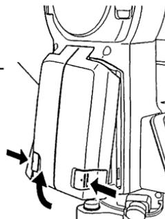
2. Вставьте аккумулятор в направлении стрелки, изображенной на корпусе аккумулятора.
