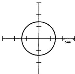
● Марка для юстировки лазерного отвеса
