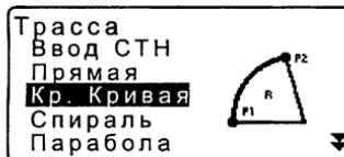
6. Нажмите **[ДА]** в экране шага 5, чтобы вычислить координаты пикета (Q) на осевой линии трассы. На экране отображаются координаты и дирекционный угол (азимут) на эту точку.
