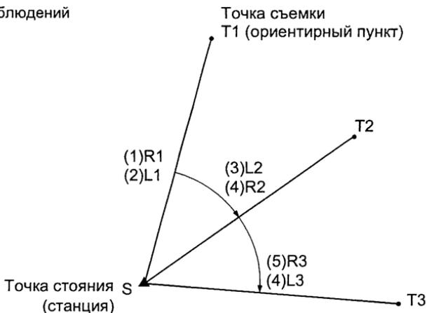
Последовательность действий при выполнении топосъемки:
