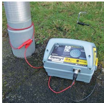
Способ трассировки кабелей малого диаметра
