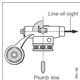
Компенсатор в инструменте отвечает за компенсацию остаточного наклона вертикальной оси, давая возможность привести визирную ось в строго горизонтальное положение.
