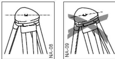
При установке штатива обращайте внимание на то, что головка штатива должна быть горизонтальна. Значительный наклон штатива должен корректироваться с помощью подъемных винтов трегера.
