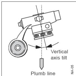
Если пузырек круглого уровня находится в нуль-пункте, инструмент почти отгоризонтирован. Остается небольшой наклон вертикальной оси инструмента.
