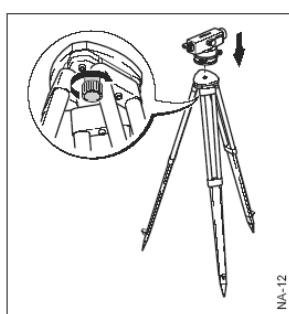
1. Установите нивелир на головке штатива. Затяните закрепительный винт на штативе.
