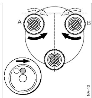
1. Вращайте подъемные винты А и В одновременно в противоположных направлениях (внутрь или наружу) до тех пор, пока пузырек не выйдет на линию, перпендикулярную линии, соединяющей винты А и В.
